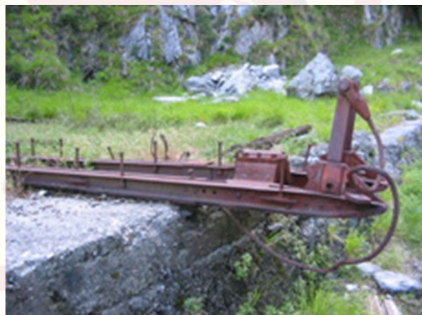
Figura 2: resti di una slitta su cui era posto il carico di marmo al poggio caricatore a quota 525 metri.
